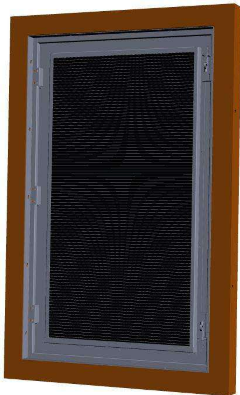
Figura 23 - griglia di areazione vista interna
